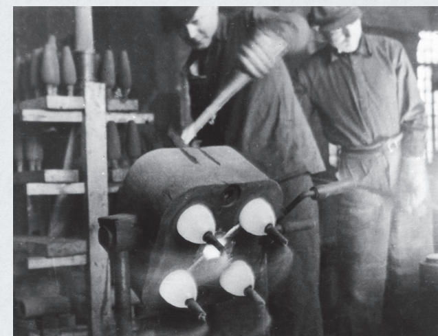
▲ Выбивка отливок 82-мм мин из кокилей в литейном цехе
